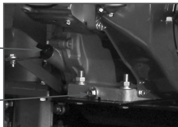
Рис. 10 Проверка уровня масла в картере
