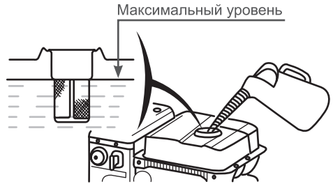
Рис. 8 Максимальный уровень топлива в топливном баке
